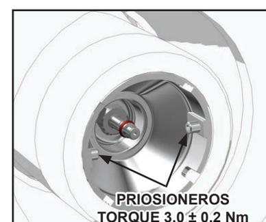
✓ Instalar el kit de acople salida sistema interno en la perforación transversal, según el procedimiento actual.
