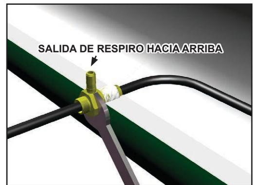
✓ Colocar el anillo orientándolo con la conicidad hacia adentro, y luego colocar la tuerca de ajuste (herramienta); sin ajustar.
