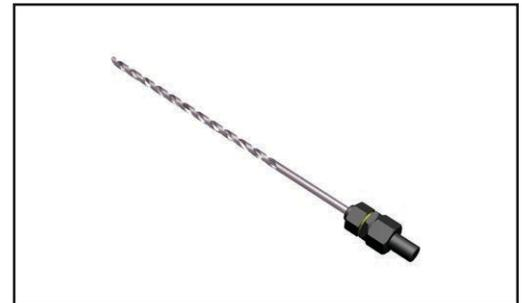
✓ Llevar la broca hasta que haga contacto con la punta del eje y fijar el tope en el barral a 35 mm.
