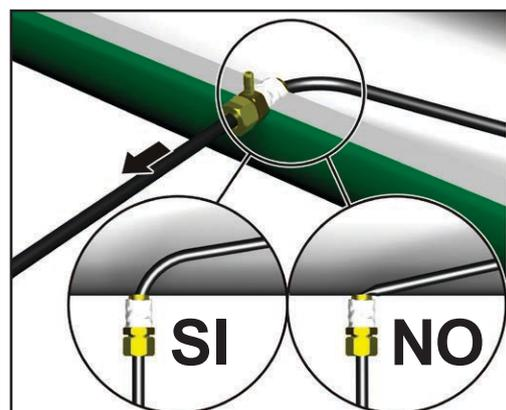
✓ Introducir el tubo 10 mm aproximadamente y ajustar lenta y suavemente la tuerca (herramienta) hasta que el tubo quede fijado (máximo 1/2 vuelta).
